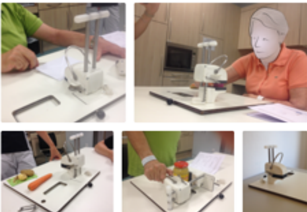
Afbeelding 3. Functioneel model: knijpsysteem aan zijkant bovendeeel, hevel achterop
